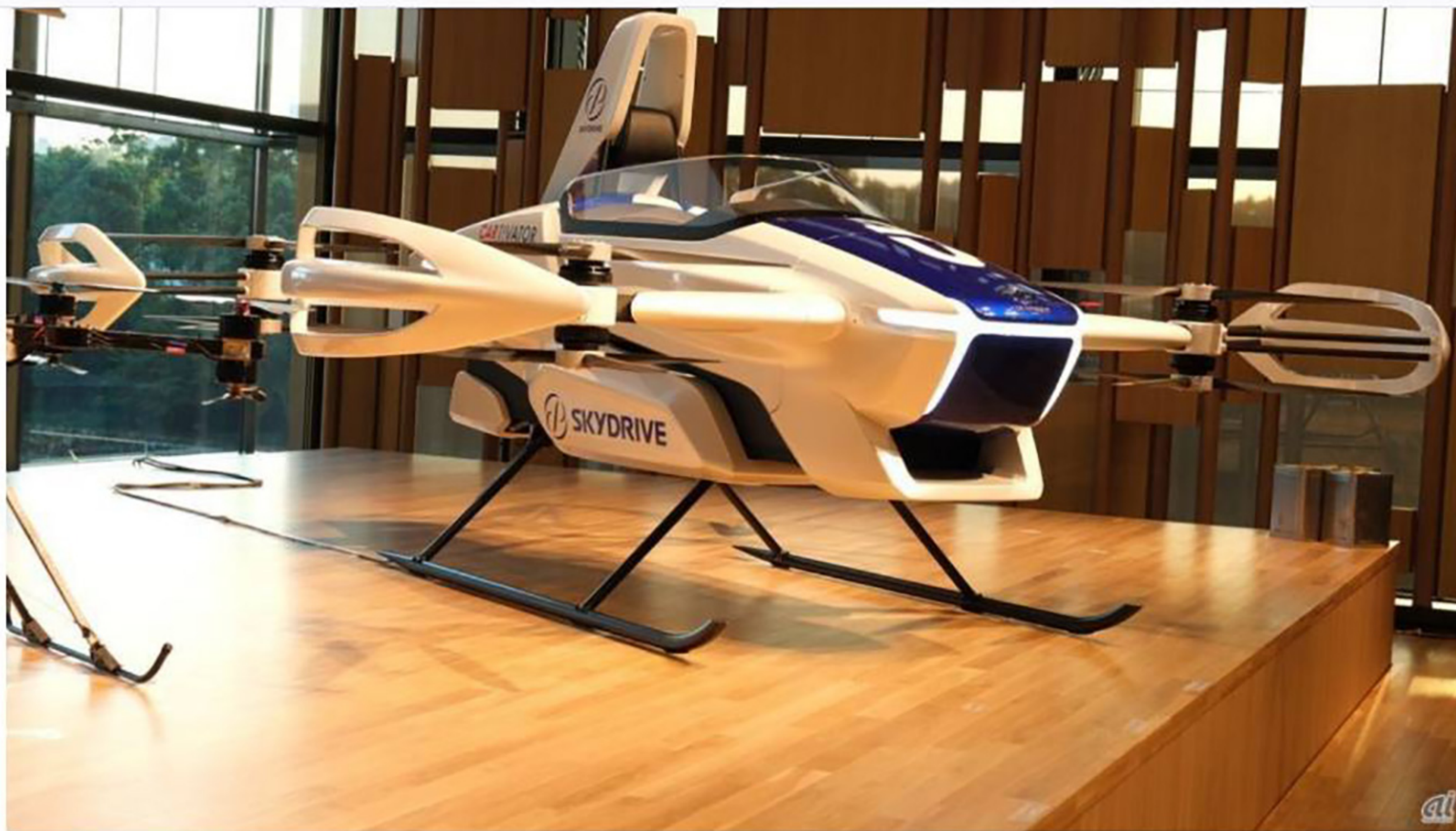
空飛ぶクルマの機体。全長4.0m、全幅4.0m、全高2.0m。重量約400kg。最高飛行速度40-50km/h。最大飛行時間5-10分程度
